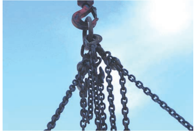
Bild 7: Ketten bzw. Seilgehänge immer auf Zug führen
